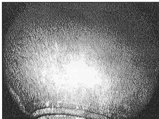
3. ábra. Alakítási nyomok a palack nyakrészén
