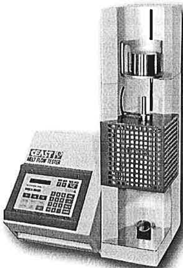
40. ábra. Korszerű folyásindex-mérő berendezés (CEAST)
