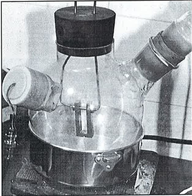
4. ábra. Az előfeszített, hullámvezetővel ellátott, bemetszett próbatest
