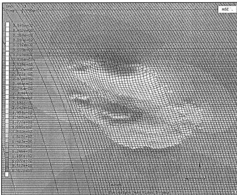
3. ábra. A redukált feszültség eloszlása egy korróziós hiba körül (K1/1 hiba; 6,9 MPa belső nyomásnál)
