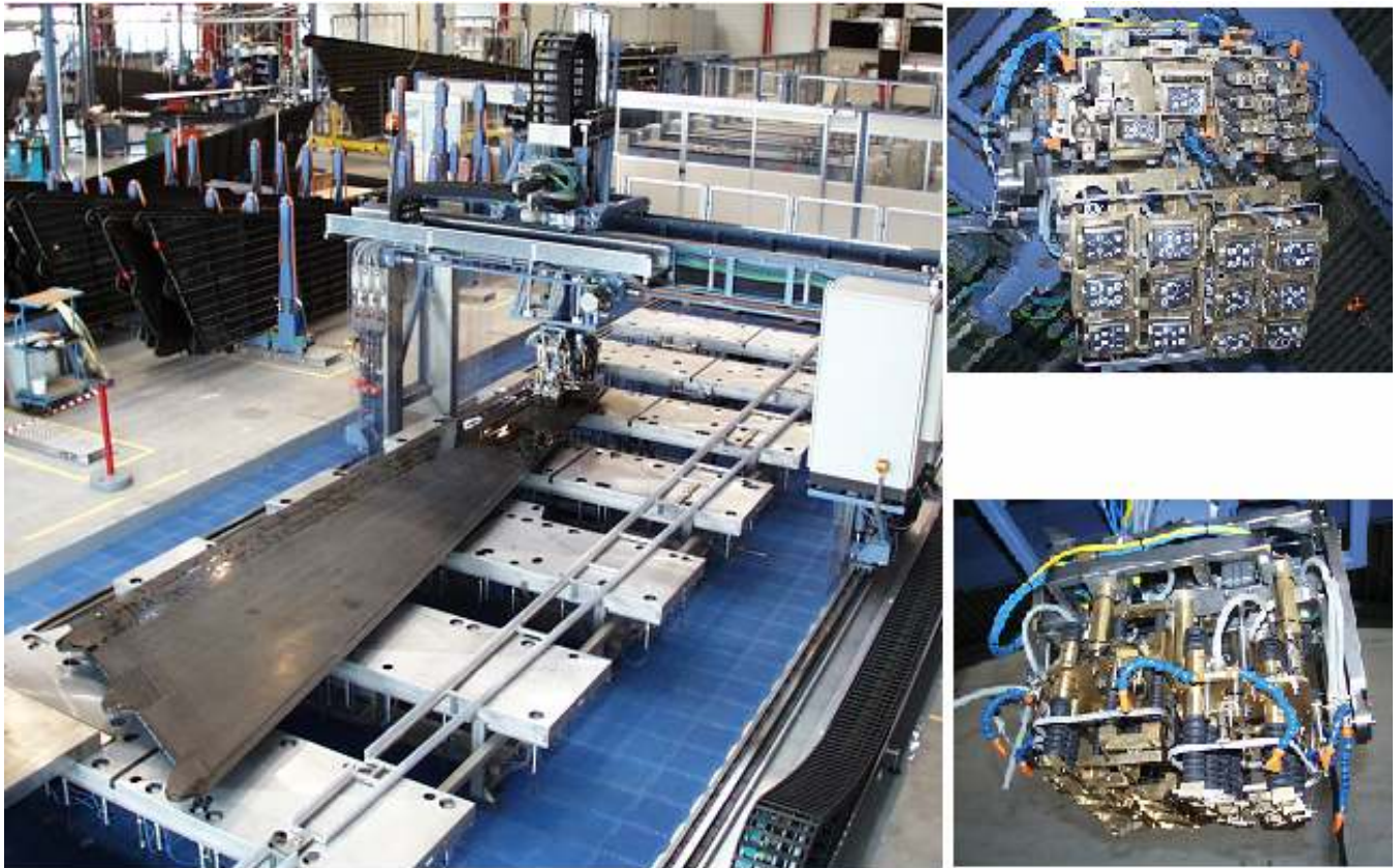
6. ábra. Vizsgálópád sárkányelemek ultrahangos vizsgálatára fázisvezérelt és hagyományos ultrahangfejekből összeállított 224 csatornás vizsgálófej-rendszerekkel
