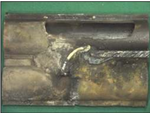
1. ábra. Membrán csőfal ablakos törése Fig. 1: Windowed fracture of a membrane wall
