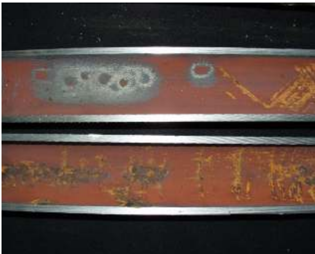
3. ábra. Általános korrózió a forrccső belső felületén Fig. 3: General corrosion on inner surface of a boiling tube
