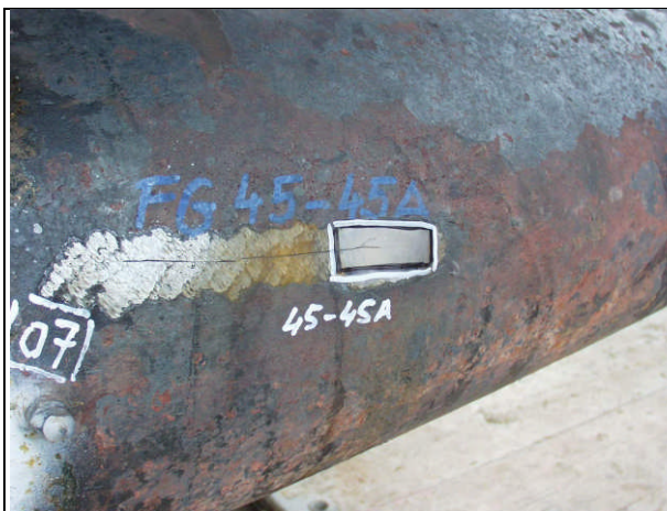
15. ábra – Gőzvezeték ív húzott szálán feltárt repedés, és az előkészített helyszíni lenyomat
