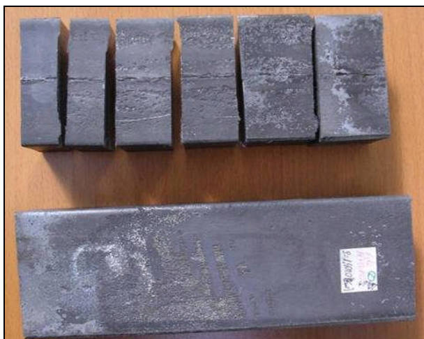
2. ábra – AISi-SL150 fémmátrixú szintaktikushab tömb és a belőle levágott próbatestek Fig. 2 – An AISi-SL150 type metal matrix syntactic foam block and sliced samples:
