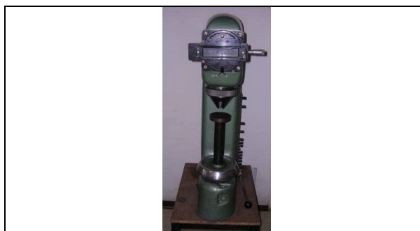
5. ábra - VPM HPO 13/6062 típusú keménységmérő Fig. 5 - VPM HPO 13/6062 type hardness tester
