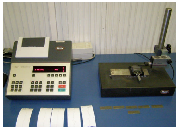
6. ábra Felületi érdességmérő
