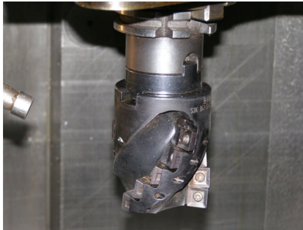
4. ábra Szerelt lapkás kukorica maró
