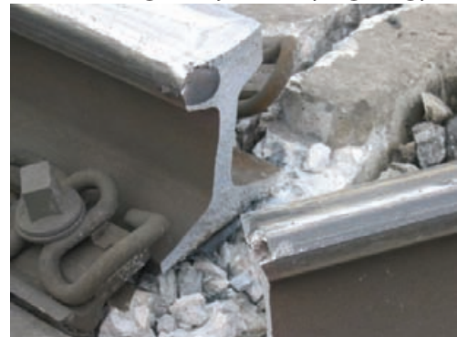
4. kép: Head Check hibából eredő sántörés
