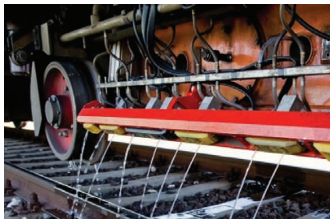
2. kép: Mérő forgóváz és mérő gerenda az ultrahangos vizsgáló fejjel
