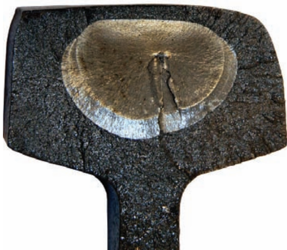
1. kép: Ultrahangos vizsgálattal kimutatott sínhiba
