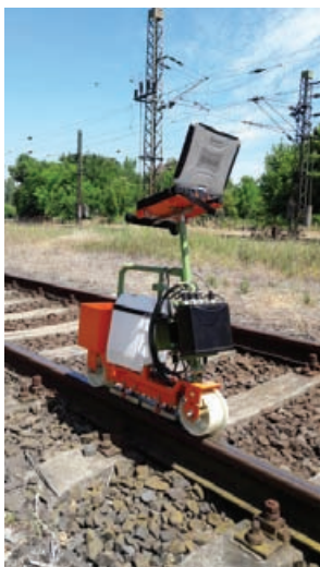
5. kép: Ultrahangos sínvizsgáló kiskocsi
