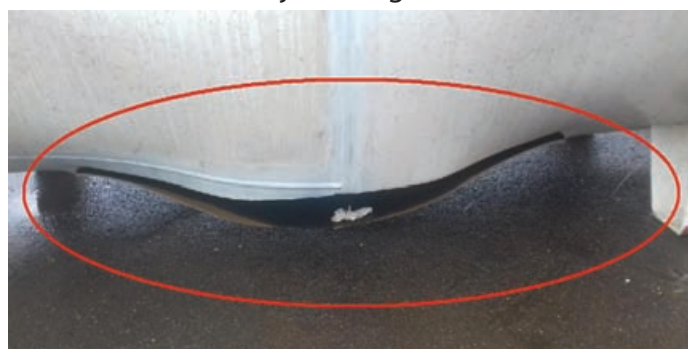
21. ábra A felszakadás a tartály alsó alkotóján mentén történt
