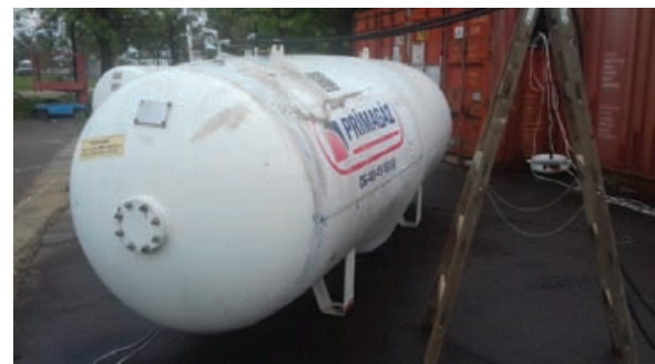
5. ábra: A II/2 sz. tartály (503694). Alul látható a felrepedés
