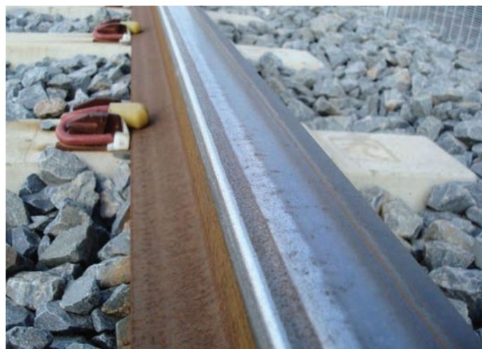
8. ábra. „Head check” károsodási folyamat során károsodott sín korai stádiumban
