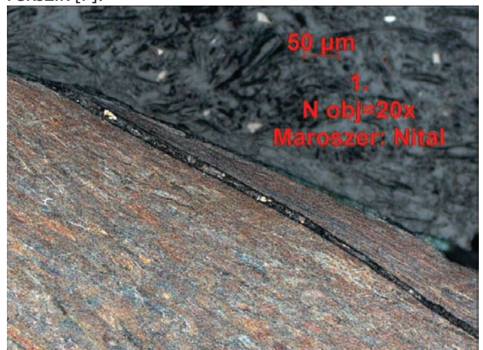
5. ábra. A képlékeny hidegalakítás hatására megnyúlt szemcséjű szövetszerkezet
