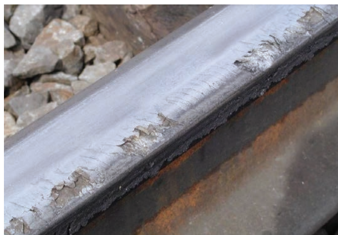
9. ábra. „Head check” károsodási folyamat során károsodott sín előrehaladott stádiumban [9]
