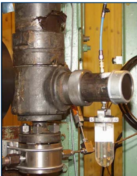
5. ábra: 325 bar nyitónyomású biztonsági szelep tömörség ellenőrzése
