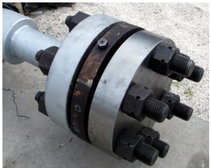
7. ábra: Kötőelemek és lencse összeszerelt állapotban
