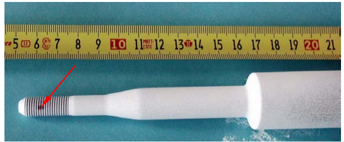
23. ábra: Repedés az olajbefecskendező menetes részén
