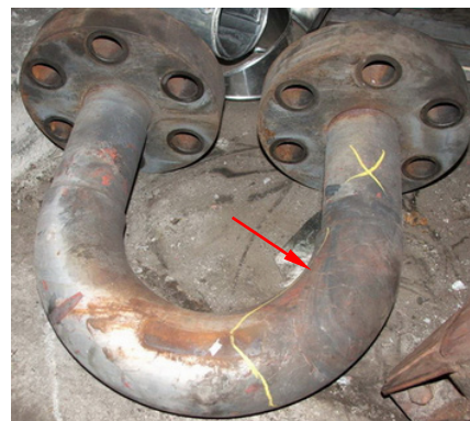
10. ábra: Dörzsöléses korrózió a nagynyomású ív külső felületén
