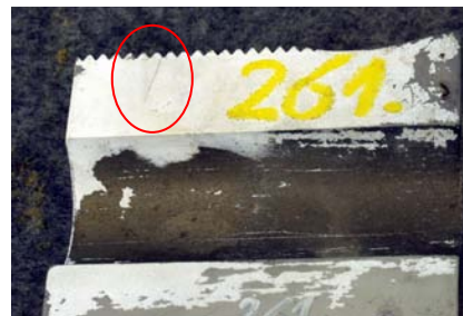
9. ábra: Repedés a kompresszorhoz csatlakozó passzdarab menetes részén
