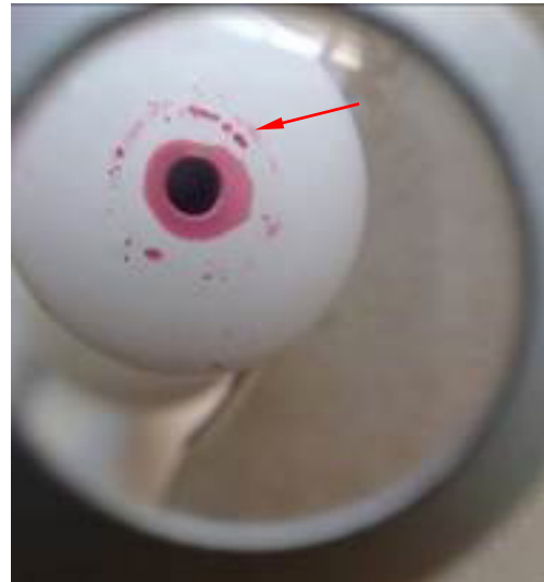
24. ábra: Repedés az olajbefecskendező tömítő felületén
