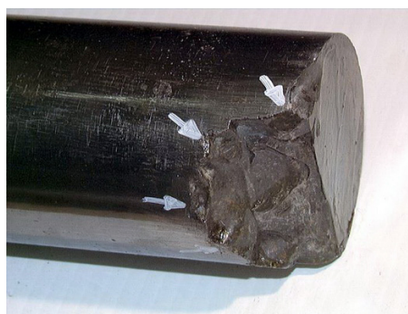
17. ábra: Törött dugattyúrúd töretfelülete
