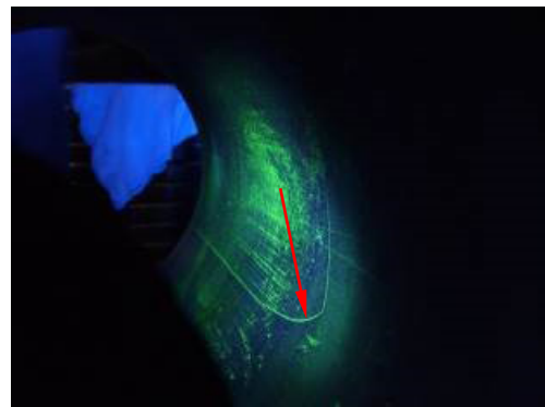
25. ábra: Repedés a hengerfej belső felületén UV fényben
