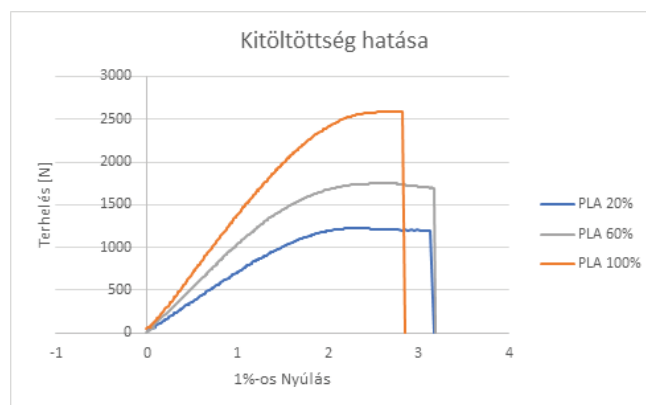
5. ábra. PLA nyomtatószáll használatával készült próbatestek diagramjai különböző mértékű kitöltések használatával
