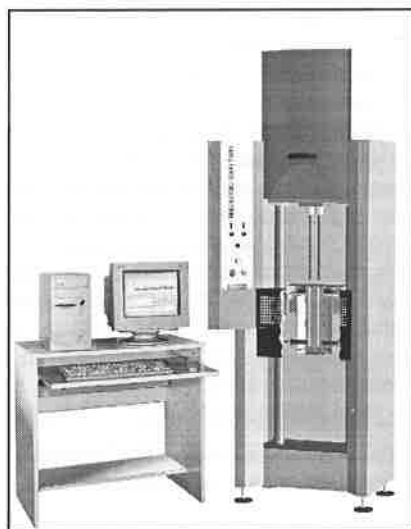
1. ábra. A Ceast Rheologic 5000-twin reométere
