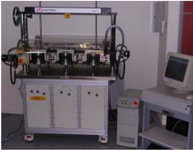
13. ábra. Az Instron több-mérőhelyes vizsgáló-berendezése gerinccsigolyák kopásvizsgálatához Fig. 13: The Instron's multi-station wear instrument for testing of spine vertebrae
