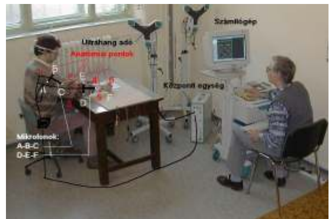
1. ábra. Ultrahangos mozgáselemző rendszer Fig. 1: The ultrasonic system for the motion analysis
