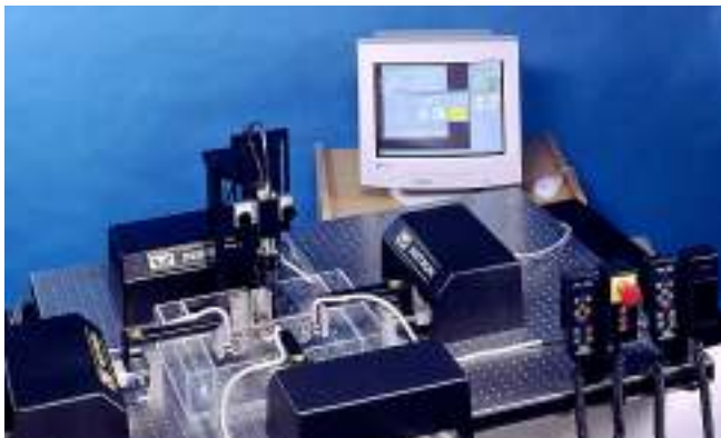
15. ábra. Az Instron Planar Bi-axial készüléke Fig. 15: The Instron's Planar Bi-axial instrument
