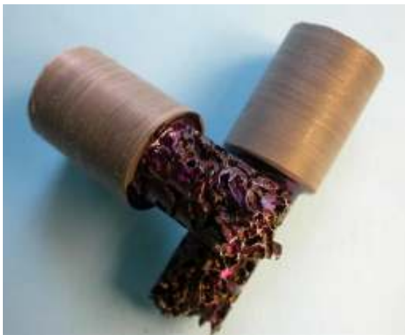
8. ábra. Nyílt cellás próbatest a szakítás után
