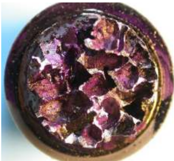
9. ábra. Nyílt cellás szakító próbatest töretfelülete
