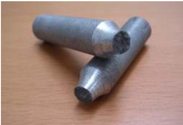
12. ábra. Zárt cellás szakító próbatest a vizsgálat után
