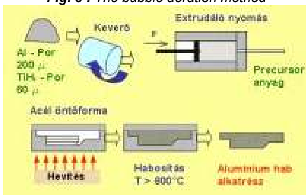
4. ábra. Porózus fém előállítása habképző anyaggal Fig. 4: Making porous metal with foaming agent
