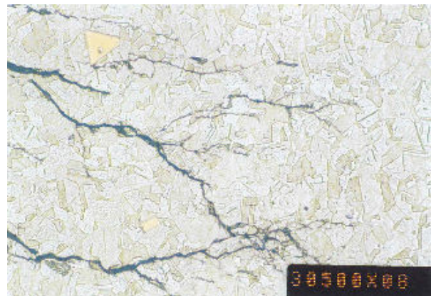
7. ábra. Feszültségi korróziós repedés, maratott Fig. 7: Stress corrosion crack; etched, N = 500x
