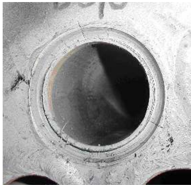
2. ábra. Egy kimart varrat az ismételt repedésvizsgálat után
