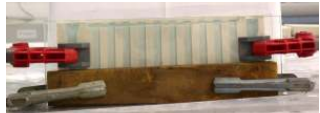
2. ábra. A MWCNT-t nem tartalmazó epoxi a szerszámműreg teljes kitöltésekor Figure 2: The unfilled epoxy resin completely filling the mould
