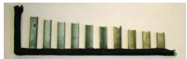
3. ábra. A szerszámműreg tökéletlen kitöltéséből adódó hibás próbatest-előtermék Figure 3: The faulty specimen caused by incomplete filling of the mould cavity
