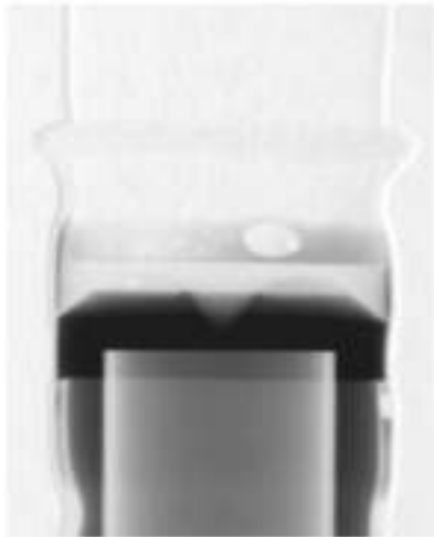
10. ábra. A vízzel feltöltött csőcsatlakozás neutronsugaras képe
