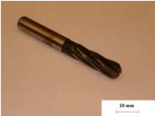
3. ábra. A „B” jelű, Ø8-as ujjmaró szerszám
