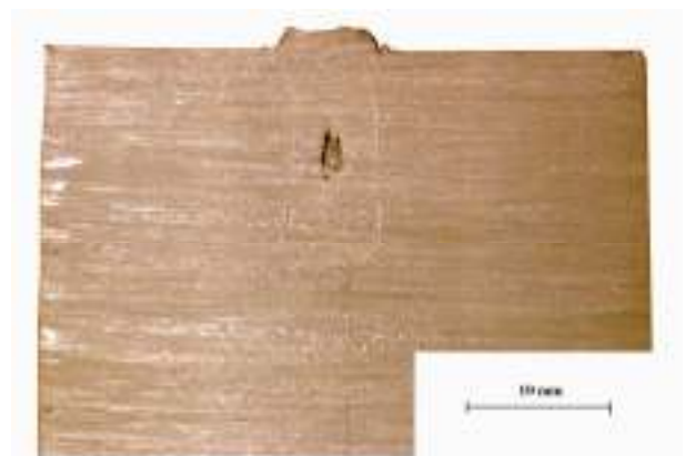
5. ábra. FSW eljárással készült varrat keresztmetszeti képe
