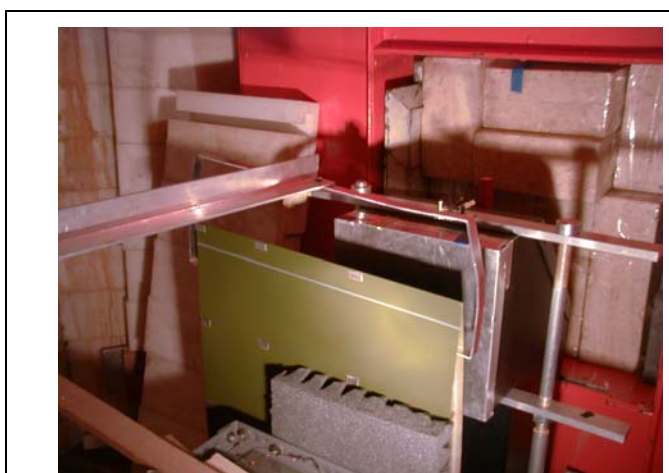
4. ábra Referencia hibát tartalmazó szektor a radiográfiai vizsgálatok közben
