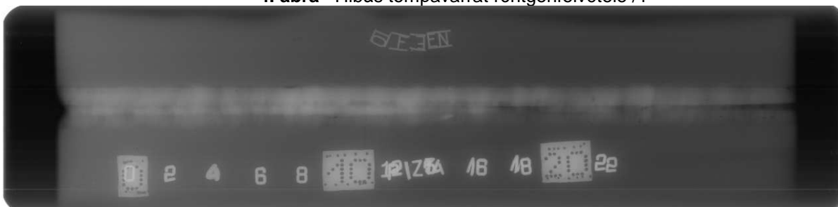
5. ábra Hibás tompavarrat röntgenfelvétele /2
