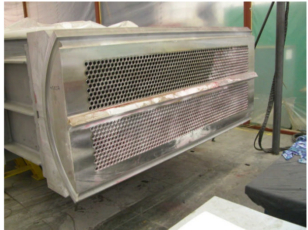
6. ábra Csőkötegfal részben már behesztett csővégekkel
