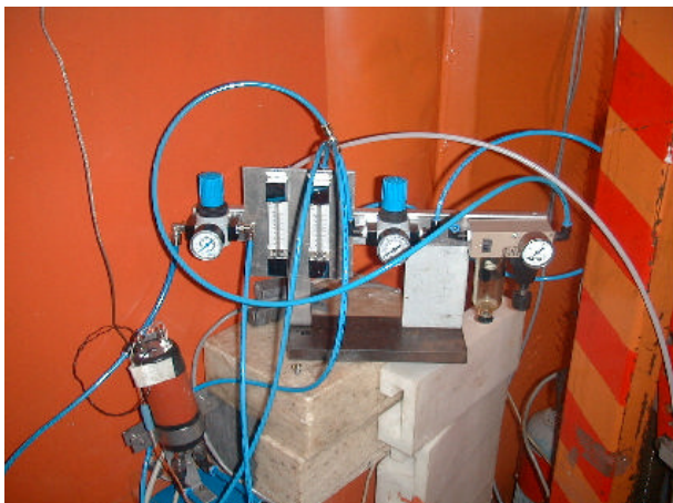
4. ábra A tüzelőanyag cellát működtető gázok mérésére szolgáló összeállítás
