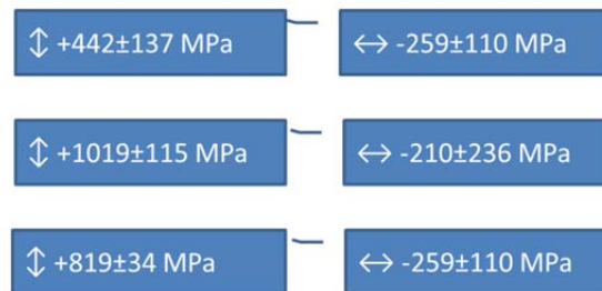
8. ábra Tengelycsuklók felületi maradó feszültsége Figure 8. Surface residual stress in axle knuckles
