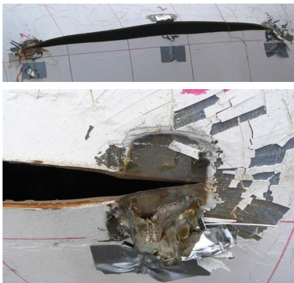
5. ábra – Öt köbméteres pébégáztartály műhibája a felszakítóvizsgálat után
