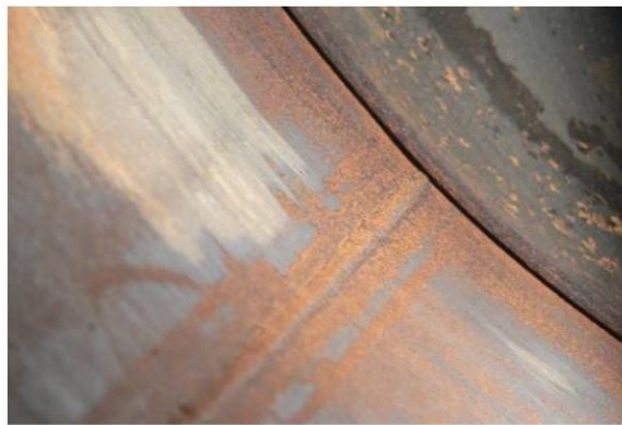
2. ábra – Egy tartály belseje. Az általános korrózió a folyadékszint feletti részeket érintette
