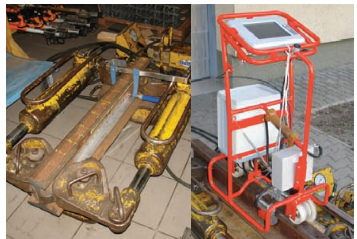
7. ábra: A feszítőmű és a kompenzációs RailScan berendezés
