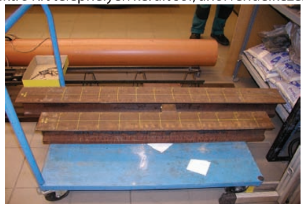
1. ábra: A vasúti sín mágnesezésére szolgáló tekercs, és a mérési pontok elhelyezkedése
