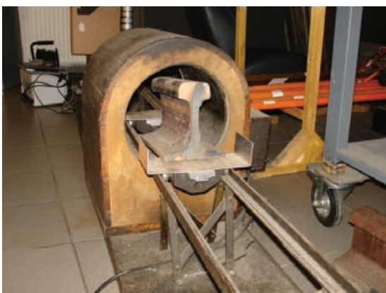
1. ábra: A vasúti sín mágnesezésére szolgáló tekercs, és a mérési pontok elhelyezkedése
