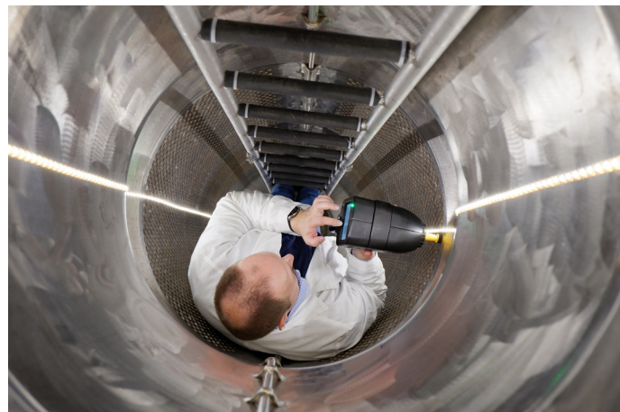
8. ábra: A gőzfejlesztő hőcserélő csöveinek APR vizsgálata
