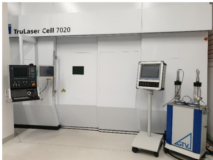
2. ábra: Trumpf Trulaser Cell 7020 típusú berendezés és a hozzá tartozó GTV 2/2 CF elnevezésű poradagoló egység
